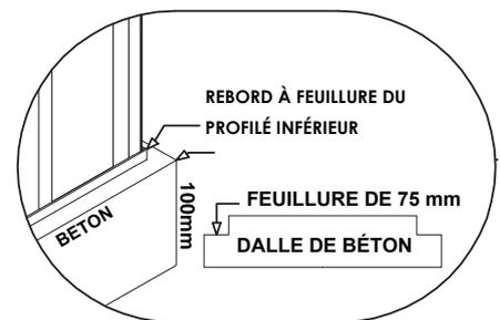
Lorsque la dalle de béton est coulée, vérifiez qu'il y a un rebord à feuillure d'une profondeur de 25 mm sur tout le périmètre de la dalle. Ce rebord est utile pour l'évacuation d'eau de la base de l'abri.
