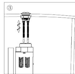
Dévisser le contre écrou du bouton-poussoir à la main. Insérer le corps bouton-poussoir dans le trou du couvercle du réservoir à l'extérieur du couvercle. Puis visser le contre écrou dans le filetage du bouton-poussoir du côté intérieur du couvercle du réservoir. (Mais sans serrer)
