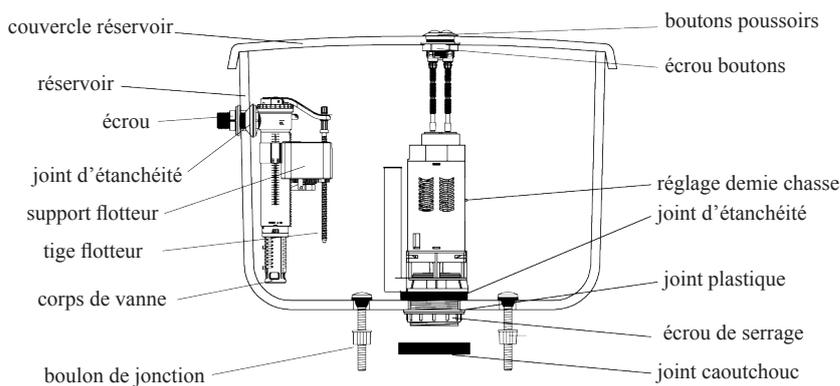
**IMPORTANT:** avant l'installation, déposer l'ancienne installation et nettoyer le réservoir. Pour une installation neuve, nettoyer le tuyau d'arrivée d'eau.
