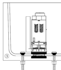
Démonter le contre écrou, installer les boulons dans les trous du réservoir, puis placer le réservoir sur la cuvette des toilettes. Fixer le réservoir à la cuvette avec le contre-écrou serré.
