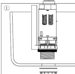
Dévisser l'écrou de serrage du mécanisme. Insérer le mécanisme dans le réservoir. Appuyer sur le mécanisme tout en le serrant avec l'écrou par l'extérieur du réservoir.
