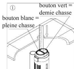
Mettre en place le couvercle du réservoir. La hauteur de tige nécessaire est celle entre la surface du couvercle du réservoir et les boutons de chasse.
