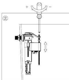
Installer le module de remplissage dans le réservoir. Appuyer le corps du module contre la paroi interne du réservoir. En même temps, insérer le joint sur l'extérieur de la tige filetée et serrer à la main l'écrou. Raccorder l'alimentation en eau puis ouvrir l'eau. Régler le niveau d'eau à la hauteur souhaitée en vissant/dévisant la tige du flotteur et en faisant coulisser le support du flotteur le long de la tige.
