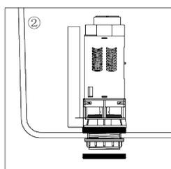
Emboîter le joint caoutchouc à lèvres sur l'écrou de serrage.
