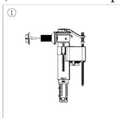
Dévisser l'écrou pour installer le module de remplissage.
