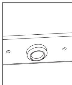
Le joint noir d'étanchéité se place à l'intérieur du réservoir. Tous les autres joints s'installent à l'extérieur du réservoir.
