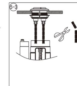
Mettre en place le couvercle du réservoir et régler la longueur des tiges de commande pour qu'elles viennent en contact avec le mécanisme lorsque le couvercle est posé sur le réservoir. Les couper si elles sont trop longues.
