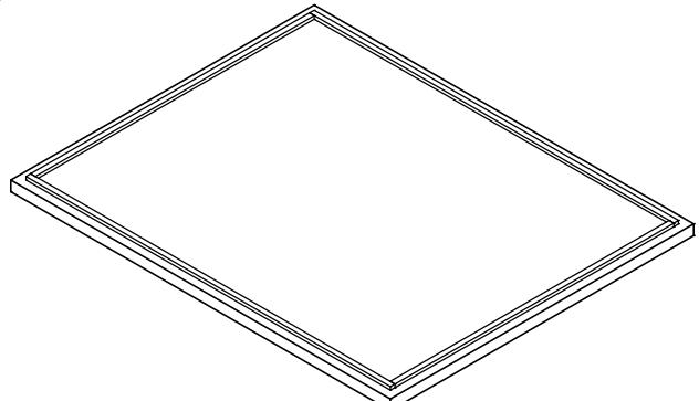
2. **Parpaing.** Sur le parpaing vous n'avez que la possibilité de poser votre abri avec le plancher. Formez le soubassement à l'aide des lisses livrées (rép. 1 et 2) et fixez-le contre les parpaings à l'aide de 8 vis 7,5x92 prévus, environ 40 cm de coté.
