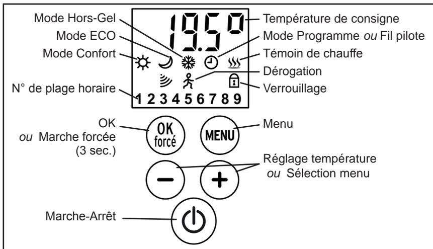
L'icône et la valeur de la fonction en cours de réglage clignotent. Le clignotement s'arrête quand le réglage est validé par la touche **OK/forcé**, ou après 30 secondes d'inaction (la modification du réglage est alors annulée).
