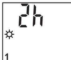
*La plage horaire ne peut pas déborder sur le jour suivant. La durée peut donc être raccourcie pour ne pas dépasser minuit (par exemple, si l'heure de début est 20:30, la durée maximale affichée est de 4h et la durée maximale réelle est de 3h30).*
