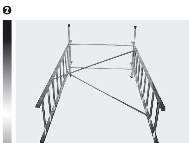
Fixer les 2 diagonales (D) entre le 2<sup>ème</sup> et 3<sup>ème</sup> barreau et le 7<sup>ème</sup> et 8<sup>ème</sup> barreau, à l'aide des vis 8x40 et des écrous (F).
