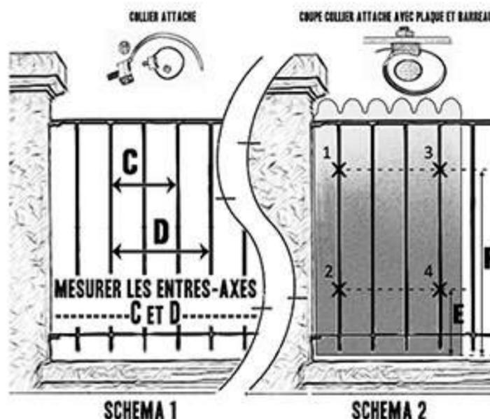
**Etape 5.** Une fois vos panneaux "FESTOCHE" découpés en hauteur, positionnez votre 1<sup>er</sup> plaque de festonnage au début de votre clôture à barreau et tracez l'emplacement des trous en fonction des entre-axes des cotes (C) ou (D) par rapport à l'écartement de vos barreaux, voir (Schéma 1).
