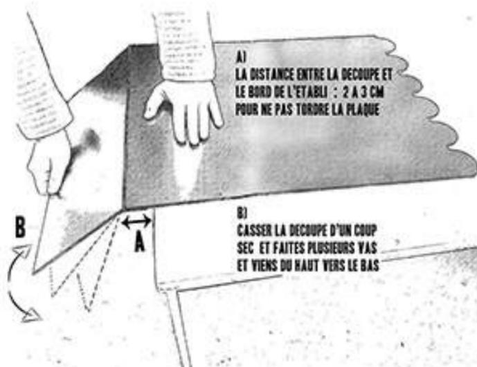
**Etape 4.** Une fois l'étape 2 effectuée sur chaque panneau "FESTOCHE", mettez la plaque sur le bord d'un établi, au niveau le plus proche de votre découpe (A) et cassez d'un coup sec la partie à découper en faisant plusieurs va-et-vient de haut en bas (B) pour que la chute se détache tout simplement.
