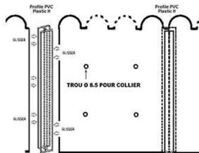
**Etape 6.** Raccordez vos 6 panneaux "FESTOCHE" à l'aide des 5 profiles H fournie, pour une jonction parfaite et esthétique. Coupez la hauteur de vos profiles H en fonction de la hauteur des plaques si vous avez réduit leurs hauteurs.
