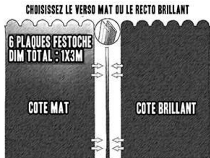
**Etape 1.** Choisir le côté mat ou brillant des 6 plaques de festonnage "FESTOCHE" en fonction de l'aspect de votre clôture à barreau.
