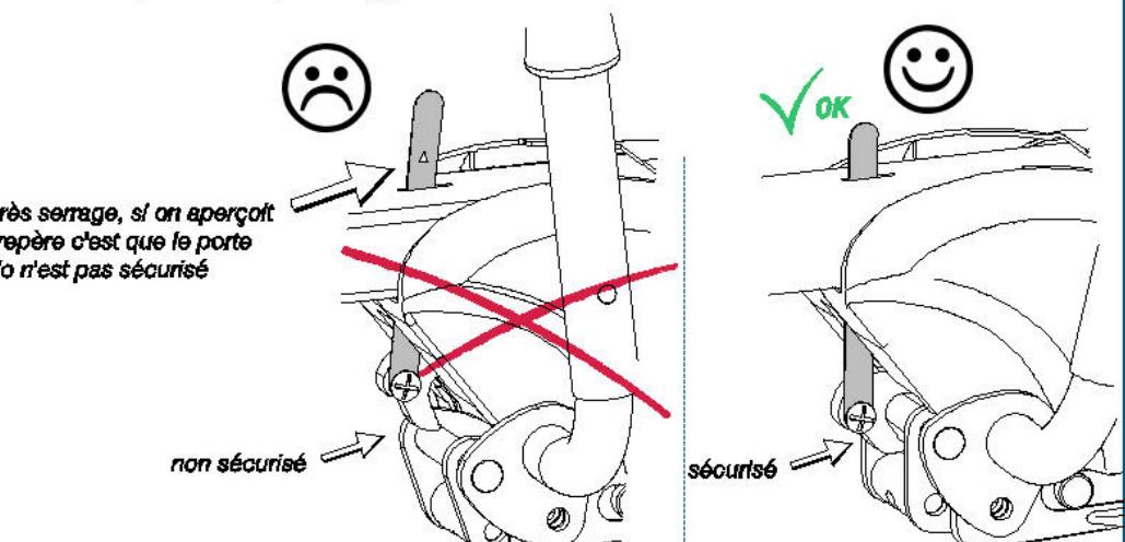
Serrer la vis de réglage manuellement, dans certains cas, le réglage peut être plus dur, le cas échéant utiliser une clé mèche 8.
