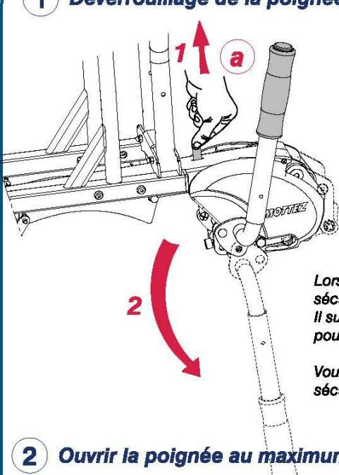
Lorsque la poignée se trouve en position serrée, un loquet de sécurité la verrouille en position. Il suffit de lever ce loquet en tirant sur la languette (vue a) pour pouvoir desserrer la poignée.
