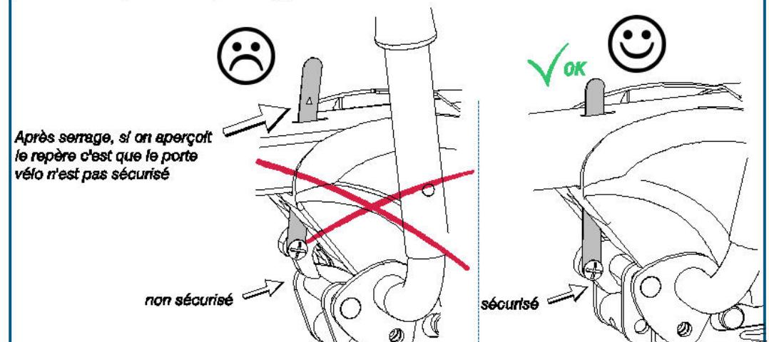
Serrer la vis de réglage manuellement, dans certains cas, le réglage peut être plus dur, le cas échéant utiliser une clé mâle 8
