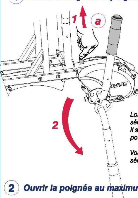
Lorsque la poignée se trouve en position serrée, un loquet de sécurité la verrouille en position.
