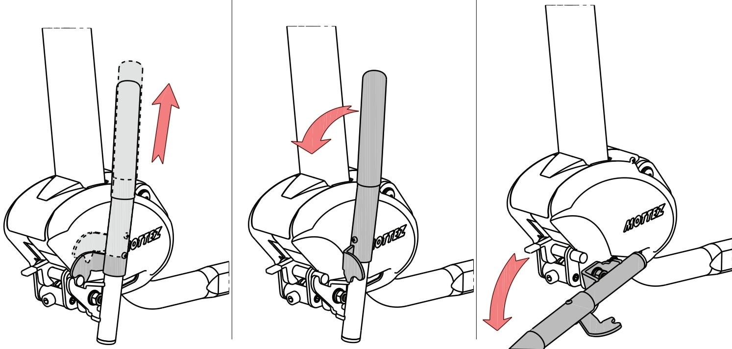
Pour ne pas gêner l'ouverture du coffre vous avez la possibilité de débrayer la poignée. Pour ce faire, levez la partie supérieur de la poignée puis tournez-la dans le sens inverse des aiguilles d'une montre. La poignée peut alors être rabattu et n'agit plus sur le serrage.
