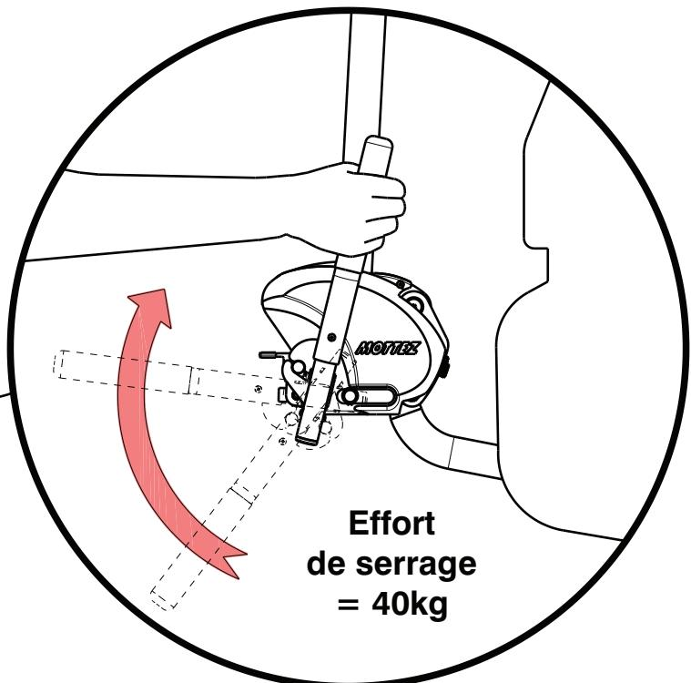
Maintenez le porte vélo en position vertical, puis, actionnez la poignée comme montrée ci-dessus à droite. Une certaine résistance doit être ressentie pour un serrage optimal. Pour ce faire, il est nécessaire de régler le porte vélo en agissant sur la vis de pression. L'effort de serrage doit être égal à 40kg.
