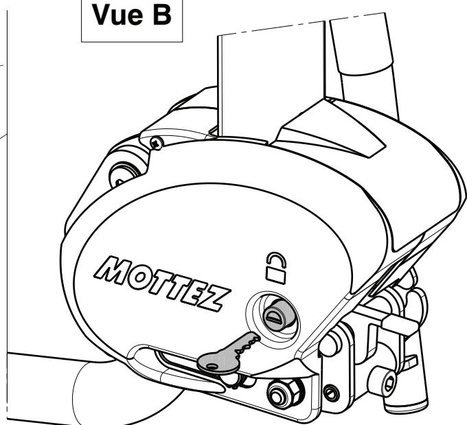
Lorsque la poignée se trouve en position serrée un loquet de sécurité empêche celle-ci de revenir en arrière. Il suffit de lever ce loquet pour pouvoir desserrer la poignée (*Vue A*). Vous avez la possibilité de verrouiller ce loquet pour plus de sécurité (*Vue B*). Ce qui **rend votre produit inviolable**.
