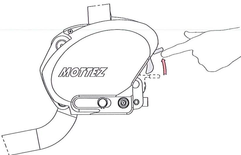
Lorsque la poignée se trouve en position serrée un loquet de sécurité empêche celle-ci de revenir en arrière. Il suffit de lever ce loquet pour pouvoir desserrer la poignée .
