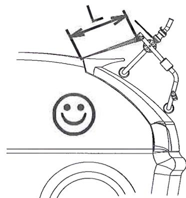
Après quelques kilomètres, vérifier que la sangle n'abîme pas le joint caoutchouc
