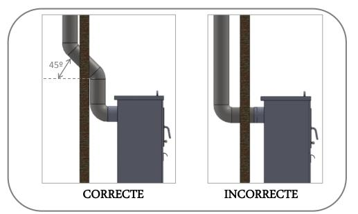
**IMPORTANT:** La fumée contient un pourcentage d'humidité. Lorsqu'elle arrive dehors, la différence de température entre l'intérieur et l'extérieur du tuyau transforme l'humidité de la fumée en goudron liquide. Ce goudron glissera et tombera alors dans les tuyaux et le poêle si les tuyaux ne sont pas correctement scellés avec de la pâte réfractaire. Comme l'explique le dessin
