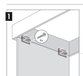
S'assurer que la trappe d'accés s'ouvre vers le bas. Fixer la trappe à l'aide des charnières fournies selon le sens d'ouverture souhaité. Il est recommandé que la trappe d'accés soit d'une épaisseur de 19mm (bois contreplaqué ou autre combi) et soit montée au ras du plafond. S'assurer que les charnières soient fixées à la fois sur l'intérieur de la trappe et sur le cadre de l'ouverture.
