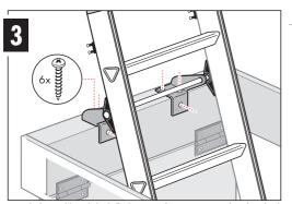
Le guide d'assemblage de l'échelle de grenier doit être monté sur le cadre à l'aide des 6 vis fournies. S'assurer que des équerres de fixations sont positionnées sur chaque extrémité du
