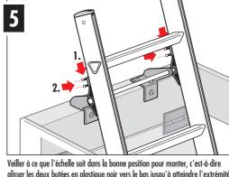
glisser les deux butées en plastique noir vers le bas jusqu'à atteindre l'extrémité supérieure du guide d'assemblage.
