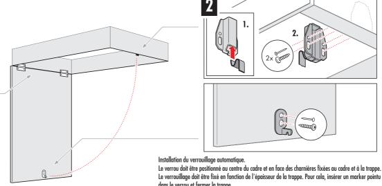
dans le verrou et fermer la trappe. La marque laissée par la pointe sur la trappe renseignera l'endroit où le crochet doit être fixé. Fixer le crochet et tester la position du verrou en ouvrant et fermant la trappe jusqu'à ce que vous soyez satisfait de l'opération.
