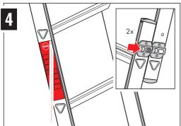
Déployer l'échelle jusqu'au sol. S'assurer que les loquets de sécurité sont engagés (position bloquée). Vérifier l'indicateur d'angle avec l'étiquette sur le côté de l'échelle et modifier la position de l'échelle en conséquence (voir image au centre).
