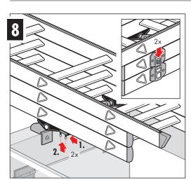
Les plans doivent être repliés ensemble, en s'assurant que les loquets de sécurités
