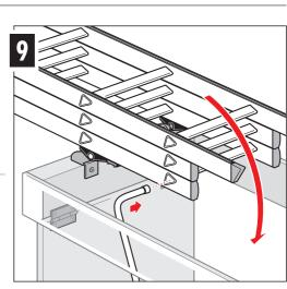
Utiliser l'extrémité de la main courante pour descendre ou monter l'échelle de grenier en l'insérant dans un trou d'échelon.
