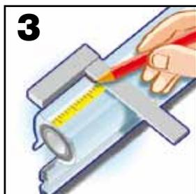
**3** La graduation adhésive tient compte d'un jeu de 1mm. Pointer sur la graduation la mesure correspondante à la largeur entre murs.
