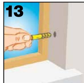
**12/13** Percez les glissières et le mur au Ø 5 mm en utilisant le gabarit.
