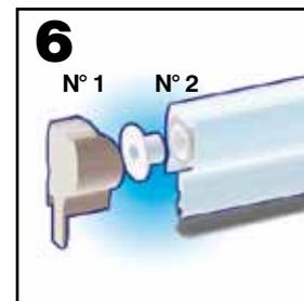
**6** Placer l'embout de tube N°2 dans l'axe puis engager l'embout de coffre N°1 sur le coffre.
