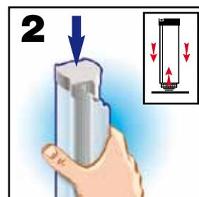
**2** Attention, avant la coupe contrôler l'alignement des éléments du coffre. Tasser celui-ci si nécessaire du côté graduation.
