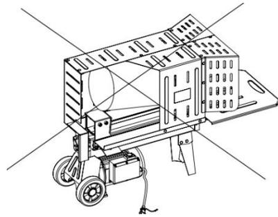
Fendre la bûche dans le sens de la pousse. Ne placez pas la bûche en travers de la fendeuse pour la fendre. Ne tentez pas de couper 2 bûches en même temps car cela peut s'avérer dangereux et peut endommager gravement la machine en entraînant de graves blessures.
