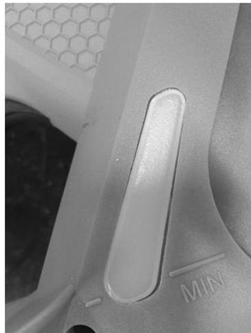
Pour ajouter de l'huile de lubrification, ouvrez le réservoir en retirant le bouchon. Mettez directement l'huile dans le réservoir. Fermez le réservoir avec son bouchon.
