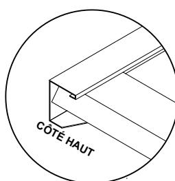
Chaque profilé en U doit être bien aligné par rapport aux tôles. Le système Snap Tite permet d'ajuster la position du profilé. Il suffit de taper dessus pour qu'il glisse et soit parfaitement aligné par rapport aux extrémités de la tête.
