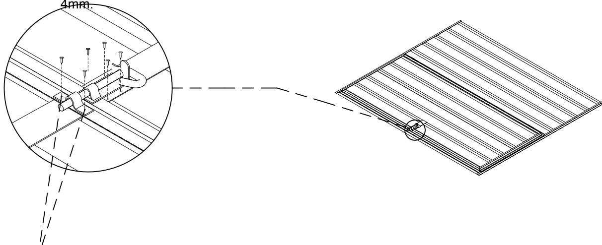
REMARQUE : les deux trous nécessaires à la fixation du moraillon du loquet pour chacune des portes n'ont pas été préperforés pour que vous puissiez les aligner correctement. Placez les moraillons au centre par rapport à la tige du loquet, percez des trous de 3 mm et fixez-les à l'aide de vis.
