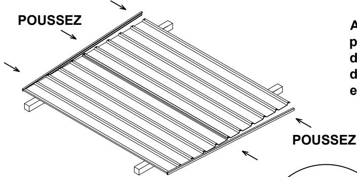
Après avoir assemblé les tôles, placez le profilé en U à une extrémité des tôles, puis tapez doucement dessus afin de l'enclencher, de part et d'autre de la tête.
