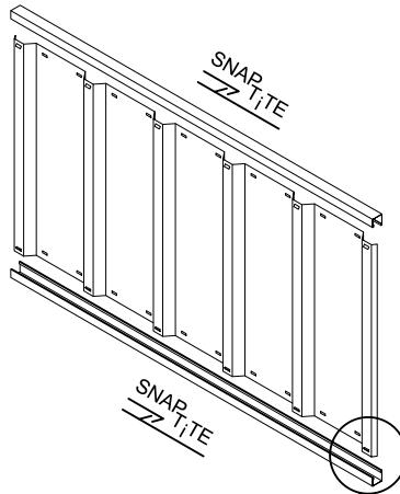
Afin de présAssembler les quatre panneaux de paroi et les deux panneaux de toiture, les profilés en U s'enclenchent en haut et en bas de chacun des panneaux à l'aide du système Snap Tite, tel qu'il illustré sur les pages suivantes lorsque vous verrez le symbole:
