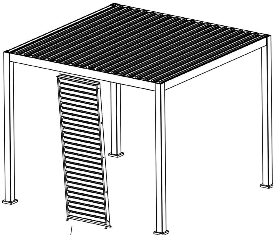
Marquer les trous sur votre sol et les percer à l'aide d'un perforateur. Enfin, taper les chevilles F dans les trous percés.
