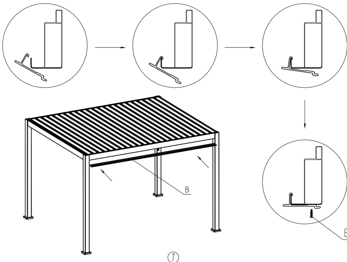
La pièce B doit être fixée entre les 2 poteaux, en respectant un écart identique de chaque côté (espace nécessaire pour le montage de la pièce C et D)
