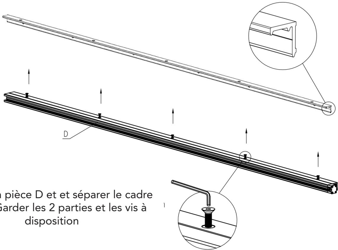
Prendre la pièce D et séparer le cadre du rail. Garder les 2 parties et les vis à disposition
