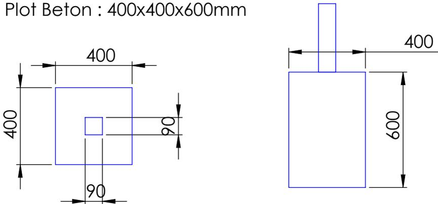
Fixation des poteaux sur plot beton obligatoirement avec des supports H non fournis
