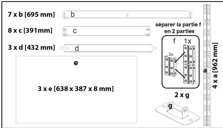
**6.** Ces éléments sont à assembler avec les 2 pieds du KIT START ou en continuité d'un autre MODULE.
