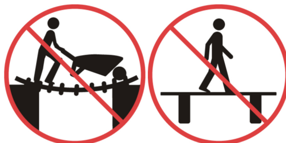
Ne pas utiliser l'échelle comme pont
