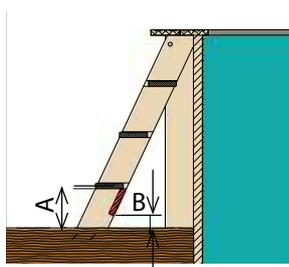
3 - Montez la marche ainsi modifiée sur l'échelle comme indiqué sur le schéma ci-dessus, en prenant soin de prépercer le limon de l'échelle.
