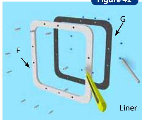
vis TF 5 x 25 en commençant par le haut. La pression des points de serrage sur le liner doit être constante (serrage en croix).
