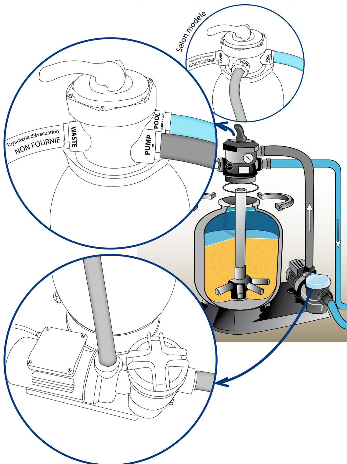
Nota : Remplissez le filtre aux 2/3 avec le sable nettoyé et calibré : un seul calibre est livré, il assure un bon fonctionnement de la filtration.
